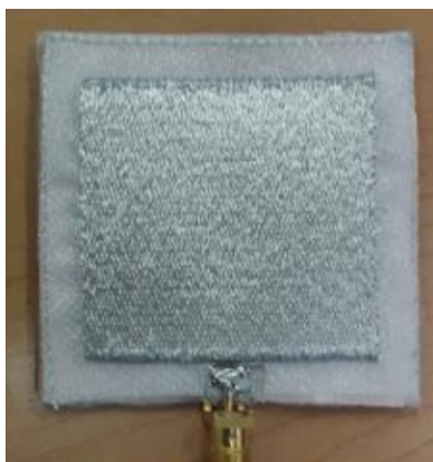
Obrázek 1.2: Nositelná půlvlnná patchová textilní anténa vyrobená tkanou technologií v pásmu 2,4 GHz, převzato z [9].
